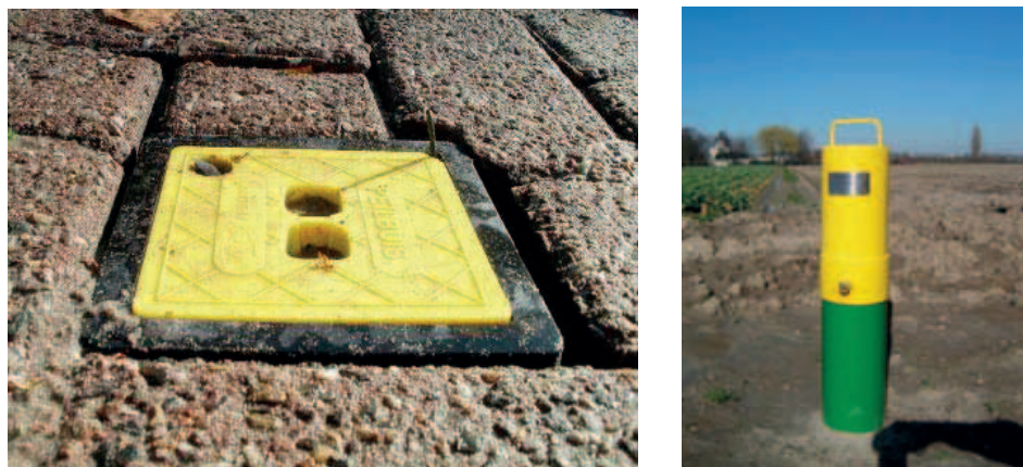
FIGUUR 3.2 AFWERKING VAN EEN PEILBUIS DOOR MIDDEL VAN EEN SCHUTKOKER (RECHTS, BRON: WILLEMSSEN, J., WATERSCHAP HOLLANDSE DELTA) EN STRAATPOT (LINKS, BRON: WARECO)
