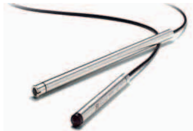
FIGUUR 4.6 ABSOLUTE (RECHTS BRON: SCHLUMBERGER) EN LUCHTDRIJK GECOMPENSEERD DRUKOPNEMER (LINKS BRON: KELLER)
